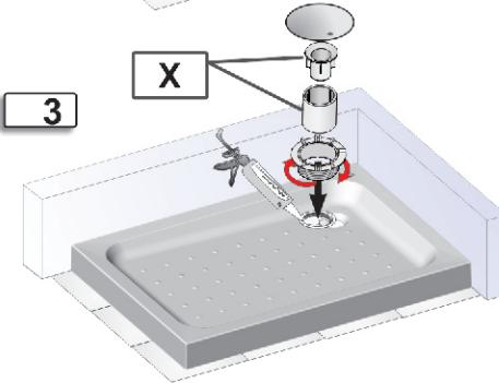
En caso de existir bote sifónico en la vivienda se eliminará el sifón del desagüe (X).
